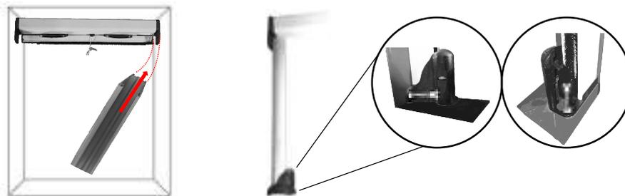
3. Baje la tela de la mosquitera hasta que el felpudo selle la parte inferior para comprobar su funcionamiento y regular la altura de los enganches.
