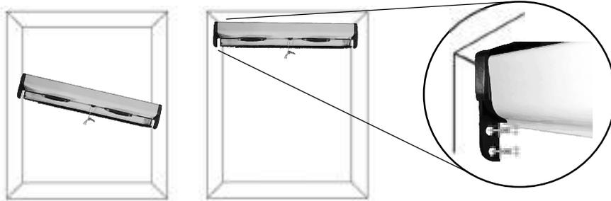
2. Coloque las guías laterales introduciéndolas sobre las pestañas del cajetín y con los soportes de anclaje hacia el interior de la vivienda. Fije las guías con tacos y tornillos.
